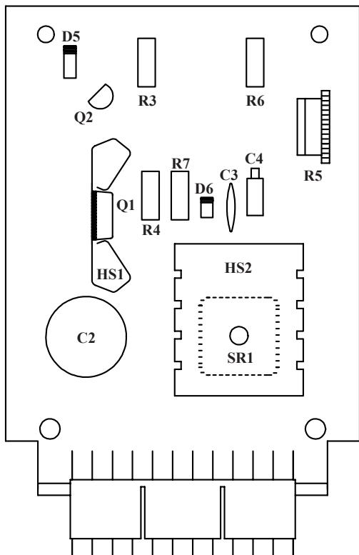
FIGURE B1 - PRINTED CIRCUIT BOARD (SN-774U)
